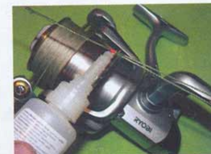
Végül pillanatragasztóval átítatjuk a visszafűzött részt és a két ütközőt
